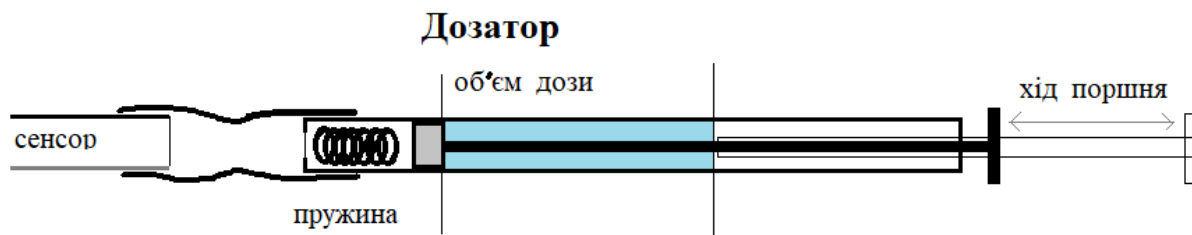
Рис. 2. Схема фіксації дози ін'єкції дослідного розчину в робочу зону сенсора
