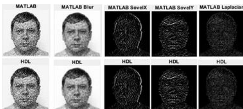
Рис. 5. Порівняння результатів моделювання MATLAB та апаратної реалізації 2D фільтрації на ПЛІС
