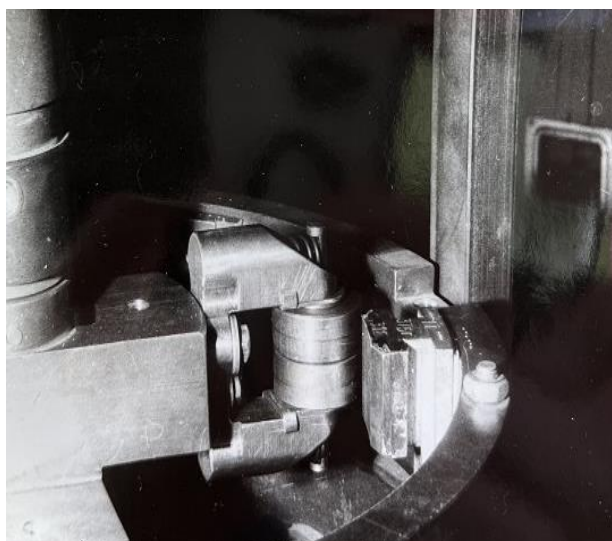
Рис. 1. Виймна роторна частина моделі перемикача серії РНТА 35/125
