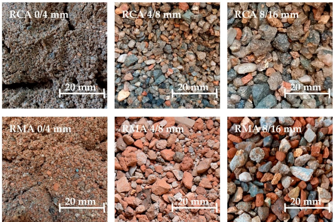
Рис. 2. Часткове заміщення природного заповнювача (20–50 %) у бетоні: фрагменти різних фракцій вторинних заповнювачів – змішаних крупних та дрібних агрегатів [2]
