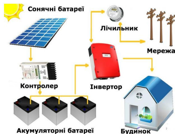
Рис. 1. Схема сонячної електростанції.
