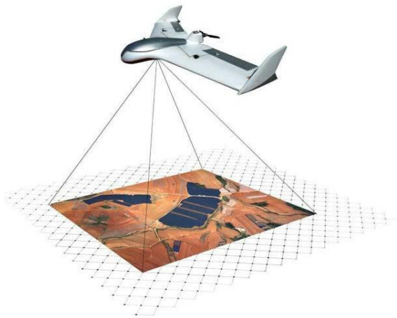
Рис. 1. Аерофотозйомка за допомогою БПЛА (отримання серії окремих знімків земної поверхні)
