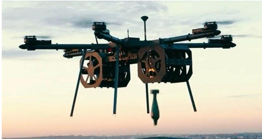
Рис. 7. Дрон, оснащений спеціальними спусковими пристроями, здатними скидати мінометні міни
