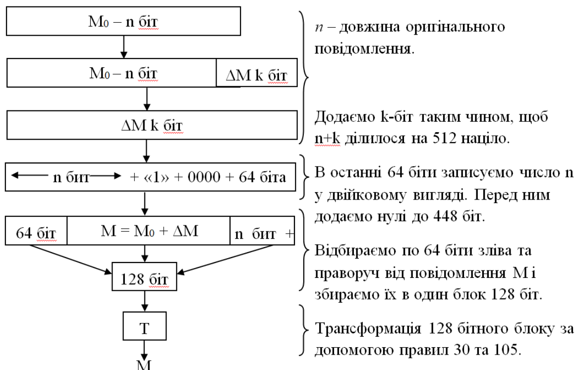
Рис. 1. Алгоритм генерації вхідного вектора.
