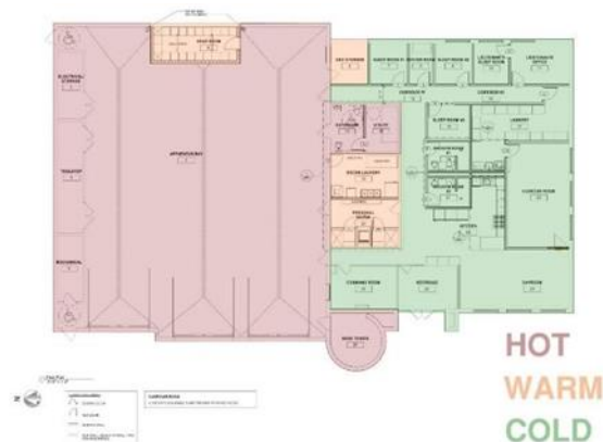
Рис. 1. Принципова схема контролю забруднень пожежного депо. Пожежна станція №1, Оберн-Гіллз, штат Мічиган, США, арх. бюро. Redstone Architects, Inc. Посил.: https://www.redstonearchitects.com/project/auburn-hills-mi-fire-station/
