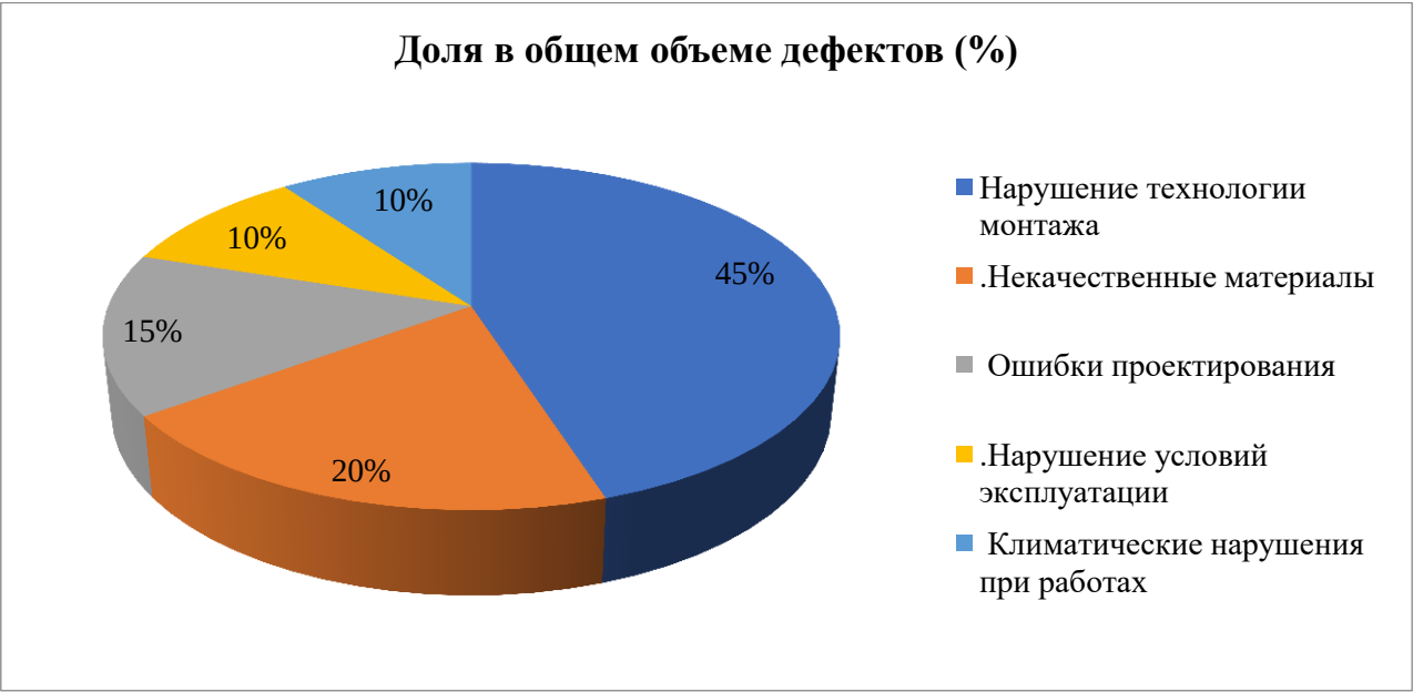
Рис. 1. Причины возникновения дефектов скрепленной теплоизоляции фасадов
