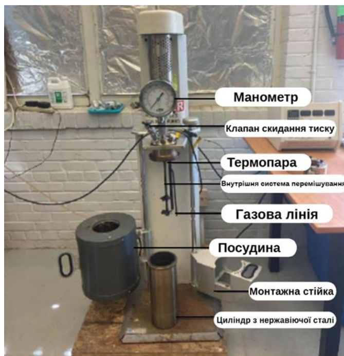
Рис. 1. Реактор Парра для гідротермальної карбонізації (2 л) та його компоненти для підтримки температури та тиску
