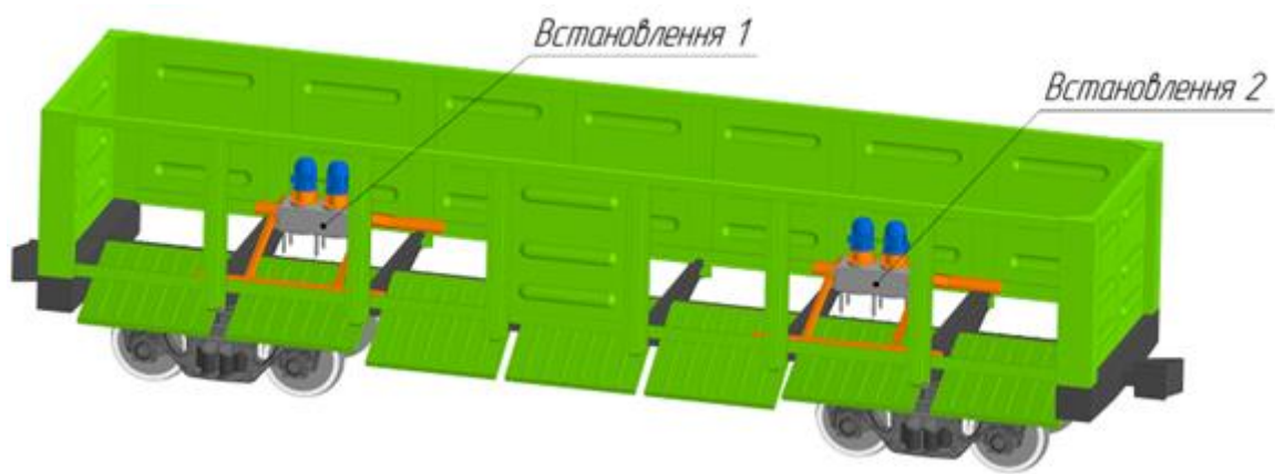
Рис. 5. Розміщення запропонованої вібромашини в кузові напіввагона
