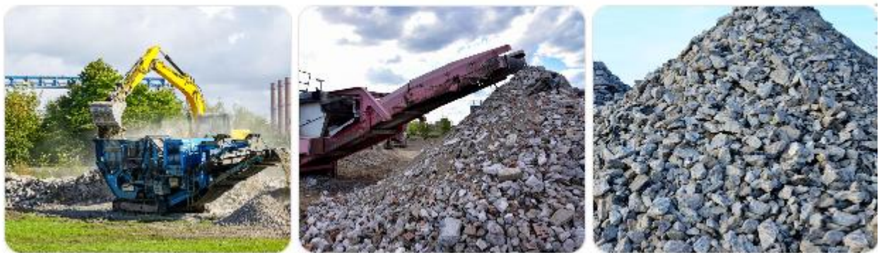
Рис. 1. Дроблення бетонних відходів для отримання вторинного щебеню (RCA)
