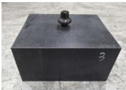
Рис. 2. Підготовлений зразок ПКШ з вкрученим шурупом
